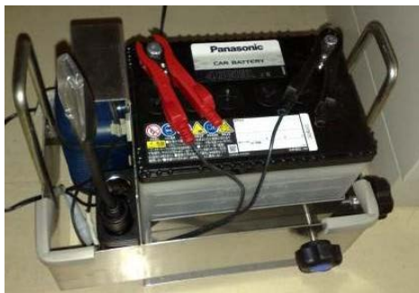
写真1 バックアップ電源試作機
